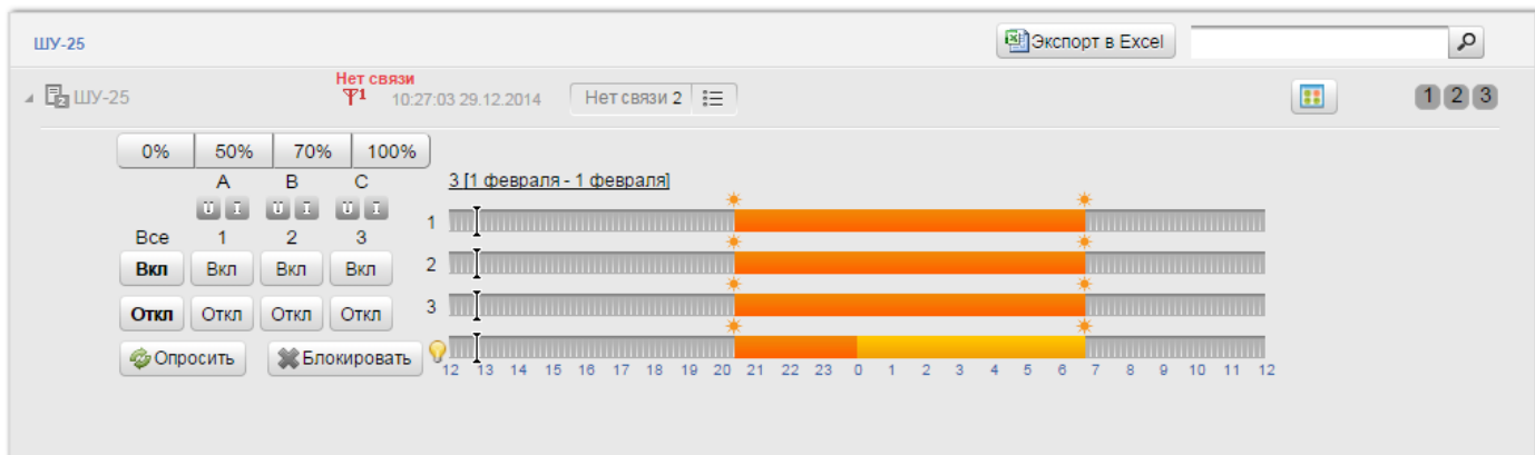
Рис. 18. Раздел «Наблюдение», объект Гелиос 2 (пофазное управление с возможностью диммирования). Расписание с типом диммирования «Светоточки»
