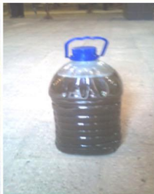
Рис.2. Вода после слива из наружного контура теплообменника
