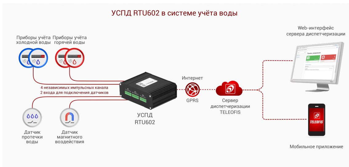
Рис.3. УСПД RTU602 в системе учёта воды.
